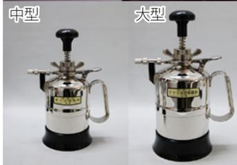
■業務用の最高級手押し噴霧器です。プロのクリーニング店で使用されています。■細かで均一な霧が特長の噴霧器です。■上部についた取っ手を上下に動かし、タンク内の空気を加圧することで、一定時間噴霧することができます。■入れられる液体の最大量は、タンク容量の70%~80%になります。■液体の量によって圧縮空気の量が変わります。噴霧時間は圧縮空気の量によって変化します。■タンク容量の違いで3種類用意しています。■溶剤にお使いの場合は霧状になると引火・吸引による中毒の危険性があります。必ず取扱説明書をお読みください。■使用後はタンク内の液体・圧縮空気を残さないようにしてください。
