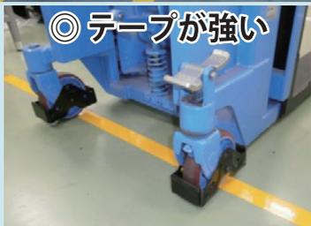
2層構造の丈夫なフィルムと強力な粘着力で破れや剥がれが少ない。
